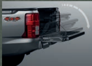
ชุดผ่อนแรงฝาท้ายกระบะ TAILGATE ASSIST SET
