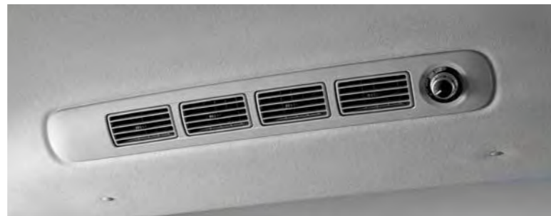
REAR CLIMATE CONTROLS WITH VENTILATION OUTLET ระบบปรับอากาศด้านหลังแยกอิสระ พร้อมแผงควบคุม และช่องแอร์สำหรับผู้โดยสารตอนหลัง
