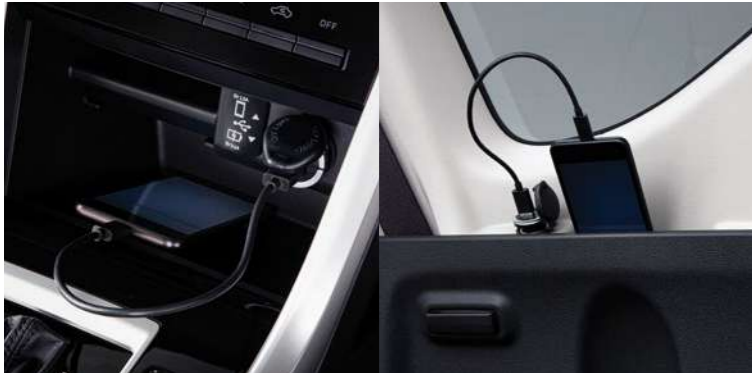
DC 12V ACCESSORY POWER SOCKET AT FRONT CONSOLE & 3 RD ROW SEATS ช่องจ่ายกระแสไฟ DC 12 โวลต์ บริเวณคอนโซลหน้า และเบาะแถวที่สาม
